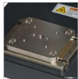
^Дополнительная монтажная пластина, различные размеры резьбы - Доступно три размера резьбы [#10-32, 5/16-18, и 1/2-20], а также массив из четыре отверстий 1/4-28.
