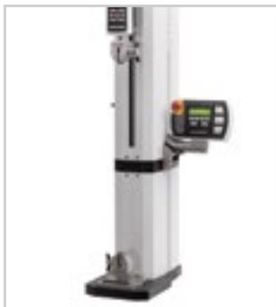
^Вертикальный зазор для длинных образцов можно увеличить удлинителем стойки. Доступны модели трех размеров - 6, 12 и 24 дюйма [150, 300 и 600 мм].
