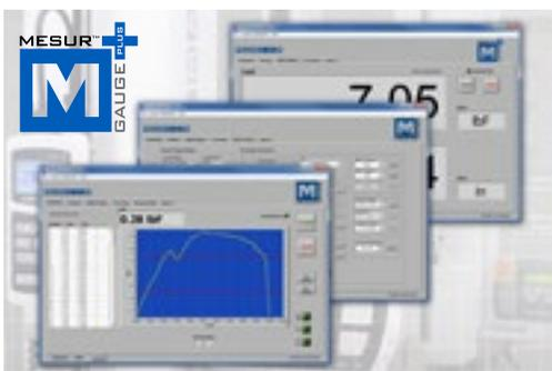
^Управления с ПК с использованием ПО MESUR®gauge Plus. Сбор данных и одновременное управление перемещением испытательного стенда с использованием MESUR®gauge Plus. Программное обеспечение строит таблицы и графики данных, вычисляет статистику и обеспечивает инструменты составления отчетов и вывода данных.
