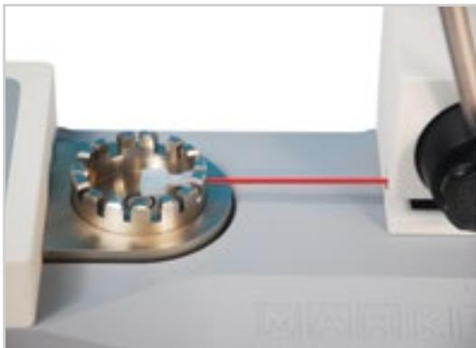
^Регулируемый зажим клемм позволяет испытывать провода диаметром до 6,3 мм/0,25 дюйма.
