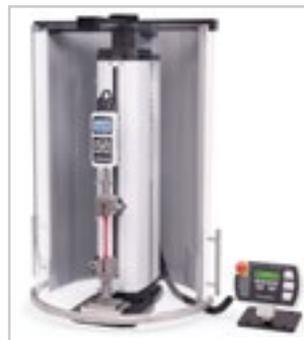
^Защитный экран защищает оператора от защемления конечностей и осколков образца. Электрическая блокировка не допускает работу испытательного стенда, пока дверца открыта.
