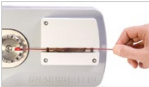
^ Прибор автоматически начинает испытание при зажиме и возвращается в исходное положение при разрыве образца. Регулируемый зажим клемм позволяет испытывать провода диаметром до 6,3 мм/0,25 дюйма.
