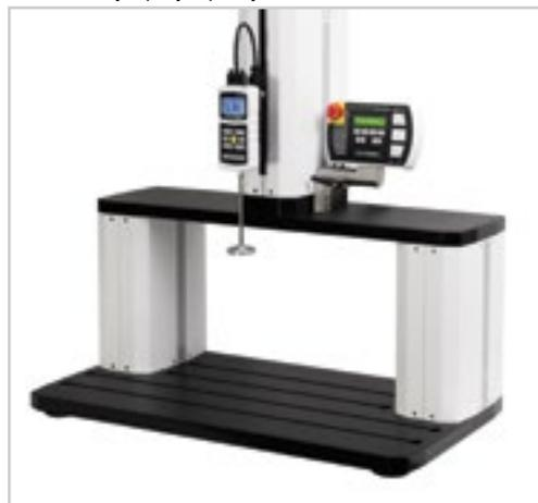
^Удлинители с двумя стойками для образцов до 20 дюймов [508 мм], либо круглых образцов  $\varnothing 21,5$  дюймов [ $\varnothing 546$  мм]. Доступны модели для высоты 6, 12 и 24 дюйма [150, 300 и 600 мм]. В основании расположены ряды Т-образных пазов для монтажа креплений.
