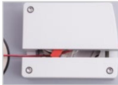
^ В начале испытания зубчатые кулачки захватывают образец. Зажимной щиток (красный) автоматически поворачивается и встает для дополнительной безопасности.
