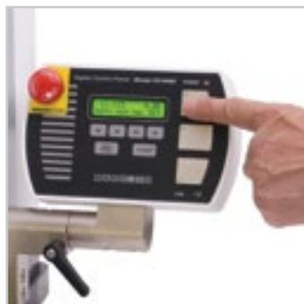
^Надежные алюминиевые кнопки перемещения вверх, вниз и останова предназначены для промышленного применения. Кнопки перемещения на ноль и FollowMe™ повышают удобство. Съемные для удаленного использования. Полный перечень доступных функций приведен на следующей странице.
