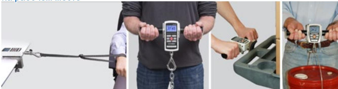
Эти динамометры идеально подходят для оценки усилий, исследований эргономики и конструкции рабочего места. Доступны с максимальными нагрузками 500 Н (100 фунтов-силы), 1000 Н (200 фунтов-силы) и 2500 Н (500 фунтов-силы).
