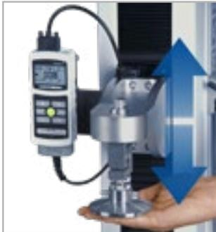
^Дополнительная функция динамического позиционирования FollowMe®. Скорость перемещения траверсы динамически регулируется вручную, нажатием или натяжением датчика. Достаточная чувствительность обеспечивает быстрое позиционирование, а также точную регулировку.
