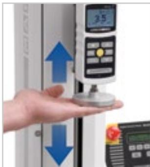
^Дополнительная функция FollowMe™ - Скорость перемещения траверсы динамически регулируется вручную сжатием или натяжением датчика. Достаточная чувствительность обеспечивает быстрое позиционирование, а также точную регулировку.
