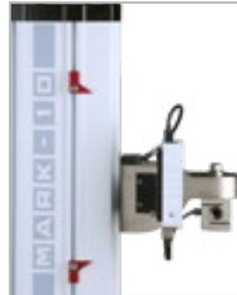
^Концевые выключатели - регулируемые верхний и нижний концевые выключатели останавливают перемещение испытательного стенда с воспроизводимостью 0,001 дюйма [0,025 мм]. Полный перечень доступных функций приведен на следующей странице.
