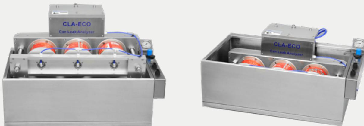
CLA-ECO специально предназначен для анализа герметичности пустых 3-составных жестяных банок. Конструкция с водяной ванной и свободно вращающимися держателями банок позволяют осматривать их корпус по всей окружности (особенно паяный шов) на наличие выходящих пузырьков. Это гарантирует, что ни один дефект не будет пропущен, и результаты испытаний будут надежными.
