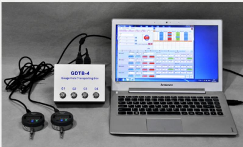
GDTB-4 является устройством для обработки данных, специально разработанным для сбора данных с цифровых датчиков компании Mitutoyo. С помощью GDTB пользователи могут собрать данные этих датчиков и переслать их для обработки программным обеспечением QUALIGAUGE. К устройству можно подключить до 4 датчиков.
