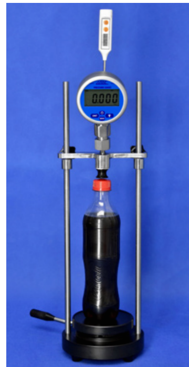
CO 2 EASY-D с цифровым манометром
