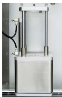
Держатель образца с устройством автоматической коррекции угла
