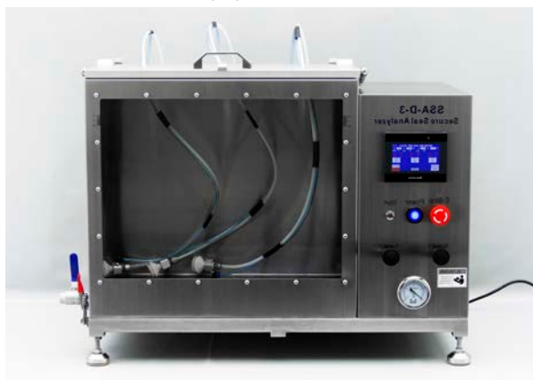
Модель SSA-D-3 на три образца
