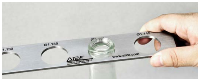
Для венчика бутылок (проверка типа «годен» или «не годен»)
