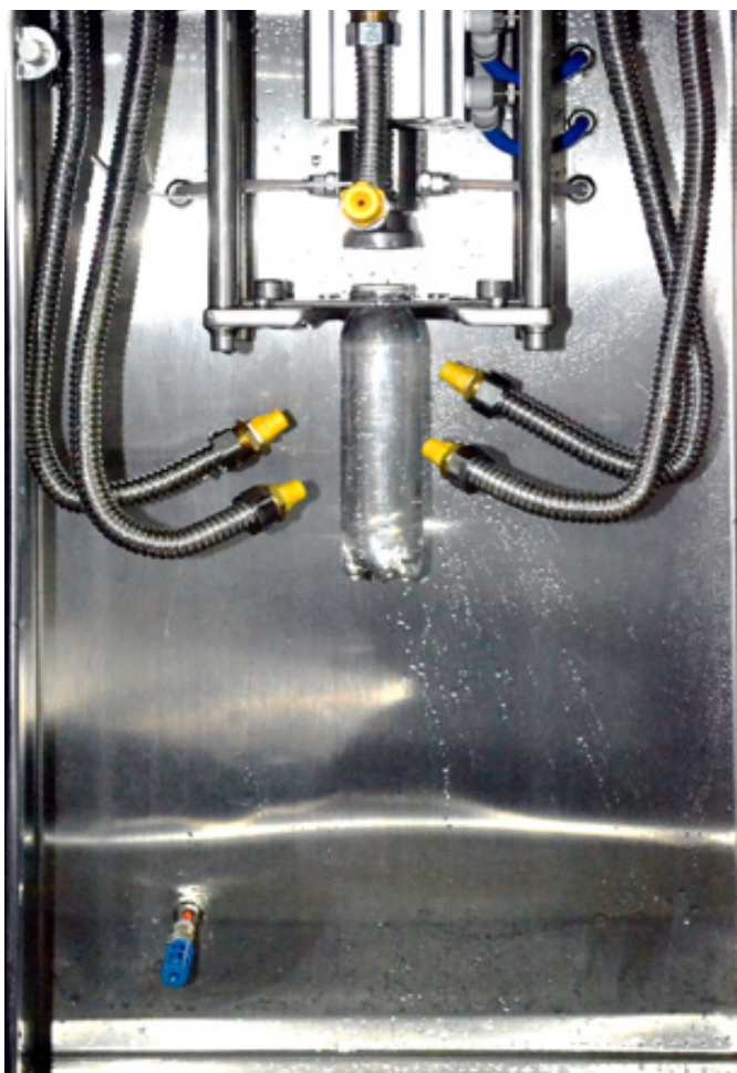
PABT с системой разбрызгивания горячей воды (по доп. заказу)
