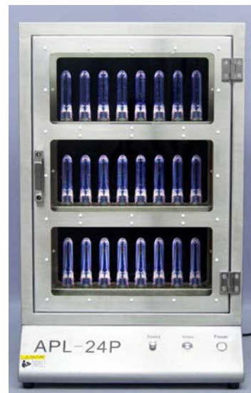
APL - с опорой преформ, функцией автоматического или ручного поворота
