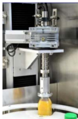
Головка открытия/закрытия с конусным зажимом или 3-х кулачковым пневматическим патроном.
