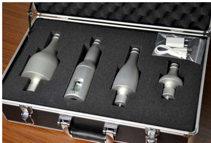
Комплект BT ETA TORQUE Один датчик для разных форм измерительных «бутылок»
