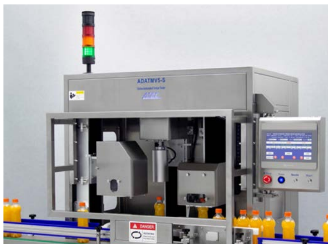
ADATMV5-S с интегрированными модулями измерения массы, угла примыкания и внутреннего давления
