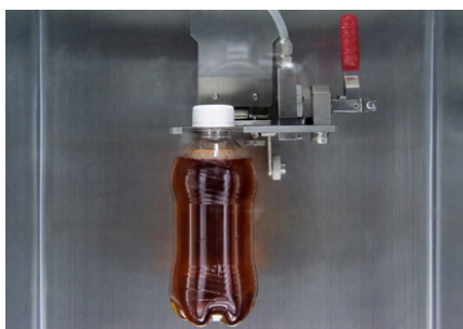
Специализированное устройство для прокалывания ПЭТ-бутылок
