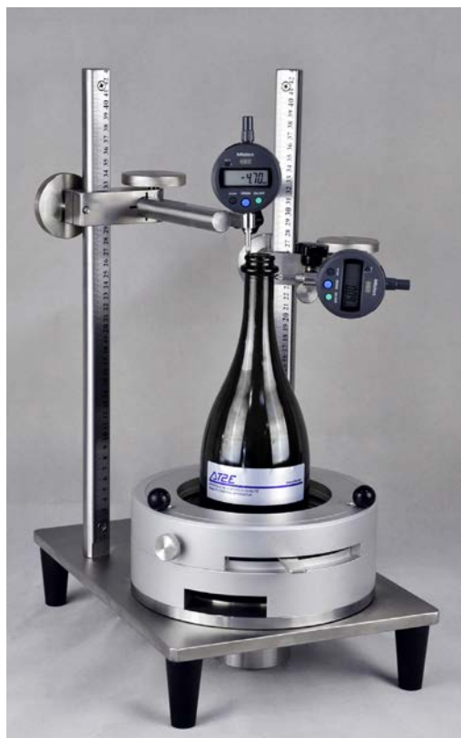
UBPT-2 с двумя измерительными головками (для горлышка и перпендикулярности)
