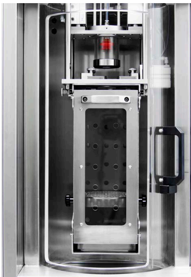
Автоматизированное прокалывание и испытание с помощью пробивной головки, запатентованной АТ2Е
