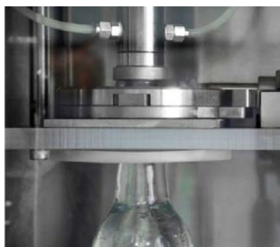
Системы автоматического зажима и наполнения водой
