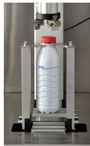
Автоматическая система зажима для ПЭТ-тары (опция)
