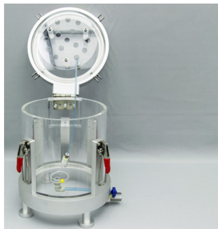
Камера с давлением и вакуумом с малой иглой
