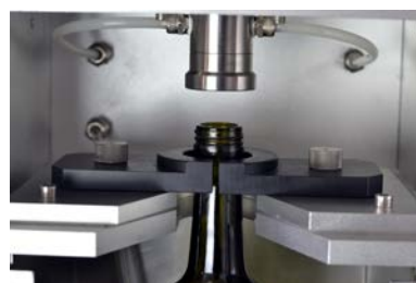
Автоматическая система зажима и наполнения водой
