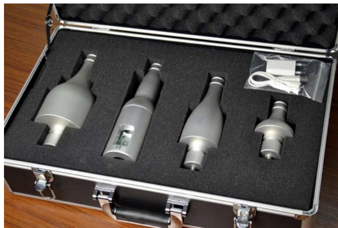
Комплект ВТ ETA FORCE Один датчик для разных форм измерительных «бутылок»
