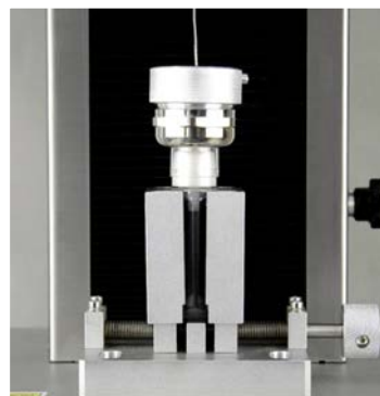
Испытание усилия помпы
