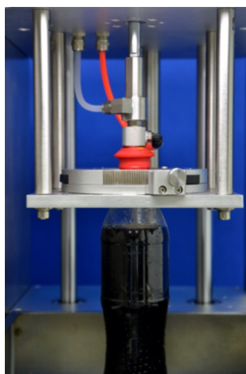
Автоматизированное прокалывание крышки и испытание с использованием запатентованной AT2E иглы
