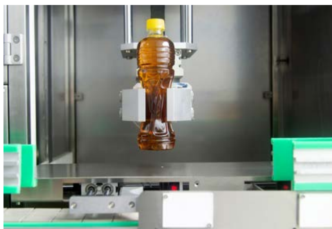
Конструкция с механическим захватом
