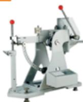
Специальный прибор для испытания гофрированного картона на устойчивость к проколам (стойкость на прокол).
