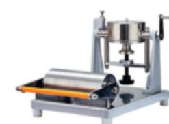
Стандартное устройство для проверки поверхностной впитываемости бумаги и картона, весовой тестер.
