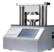
Прибор с сенсорным дисплеем разработки Yante. Он позволяет проводить испытание картона на раздавливание.
