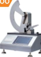
Прибор предназначен для измерения сопротивления раздиранию бумаги и картона.
