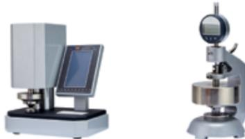
Приборы подходят для определения толщины бумаги и картона.
