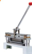
Резак для стандартных образцов бумаги используется для нарезки образцов шириной 15 мм в соответствии с требованиями для испытаний на прочность при растяжении, сжатии, изгибе, и т.д.
