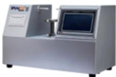
Специальный прибор для измерения жесткости бумажных стаканов.
