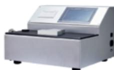
Прибор предназначен для испытания бумаги и картона на сопротивление сжатию на коротком расстоянии.
