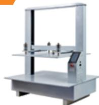
Прибор предназначен для проверки прочности картонных коробов при сжатии.
