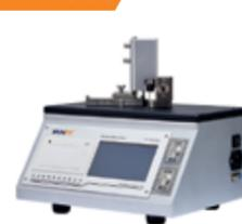
Многофункциональный микропроцессорный прибор для определения жесткости.
