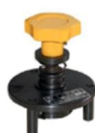
Специальное устройство для отбора проб, необходимых для испытания гофрокартона на прочность методом плоского прессования (FCT).
