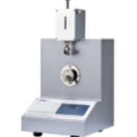
Прибор для испытания бумаги на стойкость к усталостным нагрузкам. Он позволяет определять сопротивление изгибу в виде количества складываний под определенным углом.
