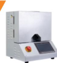
Прибор для подготовки к испытаниям на раздавливание гофрированного слоя бумажной основы методом плоского прессования (СМТ) и вертикального прессования (ССТ).
