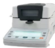
Прибор для быстрого определения влажности, который использует принцип пиролиза галогенных ламп.
