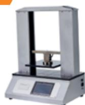
Прибор предназначен для испытания бумажных гильз и втулок на сопротивление сжатию.
