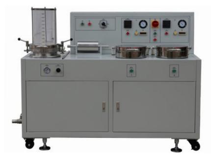
Машина формирует из целлюлозной массы образец листа, который помещает на осушитель для удаления влаги, после чего проводится изучение физических свойств образца для оценки пригодности сырья и характеристик процесса размола. Данное оборудование имеет функции вакуумного всасывания и формовки, прессования и вакуумной сушки. Управление всеми операциями осуществляется с помощью электронной системы управления.
