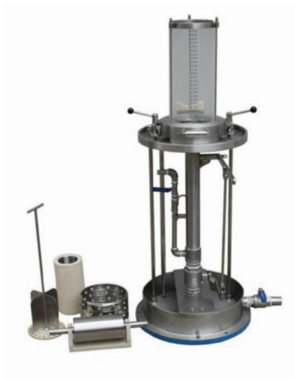
Настольный аппарат для изготовления листов бумаги традиционным методом с ручной мешалкой массы. Наполнение осуществляется через впускное отверстие, к которому подключается напорная водопроводная сеть, а опорожнение — самотеком через выпускное отверстие.
