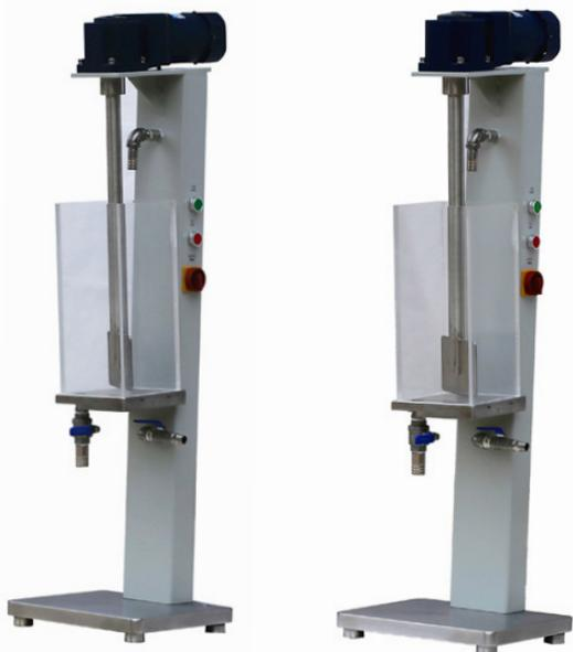
Прибор предназначен для гомогенизации пульпы после роспуска. Для предотвращения осаждения пульпы до формирования или исследования ее характеристик в лаборатории пульпу необходимо поддерживать в однородном состоянии, с постоянной садкостью, в виде суспензии.
